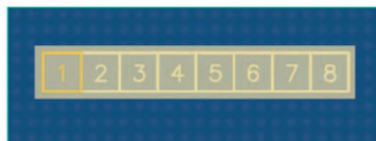
Fig. 2 – La rimozione della maschera di saldatura permette di effettuare l'ispezione visiva della numerazione degli strati
