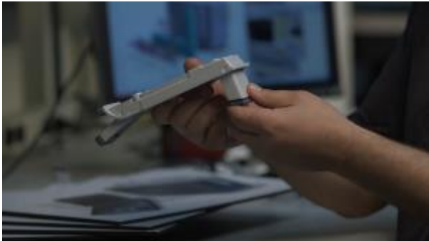
Fig. 6 – Un meccanismo di blocco impedisce ai piedini frontali di piegarsi quando un MSO Serie 5 viene inclinato in avanti
