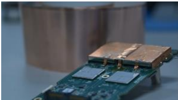
Fig. 4 – il team di progettazione ha utilizzato nastro di rame per un valore di circa 300 dollari per realizzare una soluzione di schermatura metallica idonea per gli ingressi del front end
